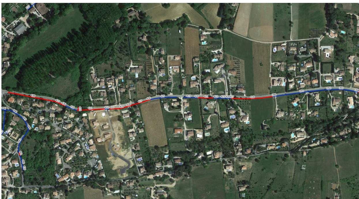
Figure 83 : Recalibrage du réseau pluvial route de Vins
